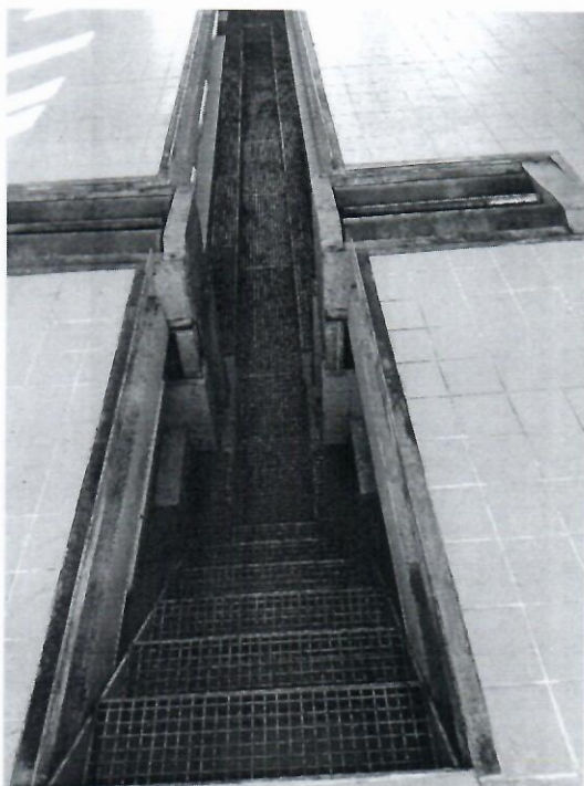
Valjci za ispitivanje kočnica
